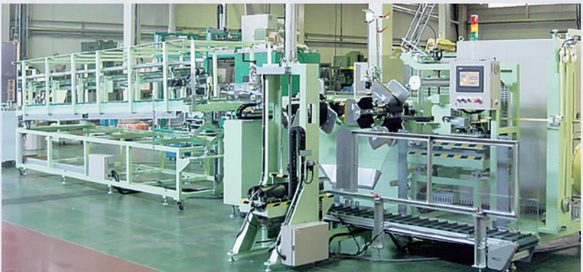
全自動巻取機 押出成形された樹脂ホースや チューブを自動で巻き取ります。
